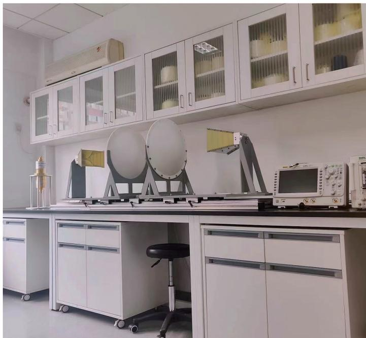
5. 建立了适用于纱线 / 织物 / 服装等的综合测试平台，可实现材料电磁参数与制品电磁效能的测试及评价。
