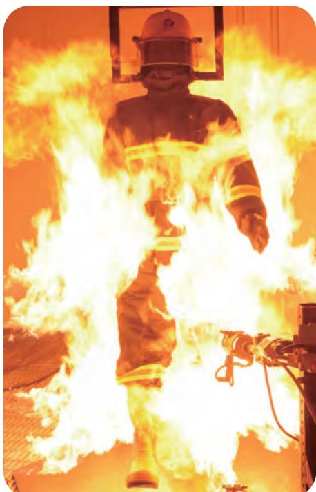
热灾害环境服装热防护性能的精准评估是决定人体安全水平的关键因素。由于热灾害环境的危险性，往往采用实验装置或数值建模方法模拟着装人体热传递过程，评估热防护服装性能，但热灾害环境存在多耦合属性，人体温度采集装置需具备皮肤热物性、三维传热等特征，同时柔性服装导致衣下空间呈现不规则三维形态等。这些关键因素导致现有技术无法实现热灾害环境着装人体的三维热传递模拟，难以准确评估服装热防护性能，一直是行业的难点痛点，成为制约热防护服装产业发展的瓶颈。
