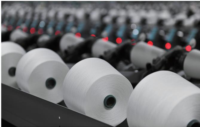
项目从纱线特征参数的智能化调节着手，攻克了直径及捻度大幅度变化的纱线及产品智能化生产关键技术，包括：（1）数字化纺纱卷捻牵伸集成控制系统：采用 IGBT 集中控制单元实现对主轴、卷捻、牵伸的并联式同步控制，成功开发独立多电机同步控制系统；（2）捻度大幅度变化纱线及产品制备技术：以所构建的三角区内纤维张力分布模型为基础，开发了变捻纺纱模块；（3）直径大幅度变化纱线及
